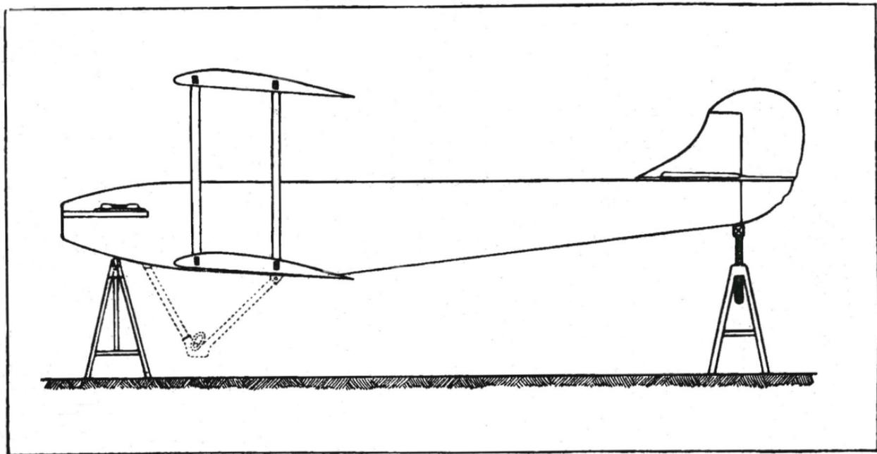
FIG. 28 - POSIZIONE DELLA FUSOLIERA PER IL MONTAGGIO DEL CARRELLO
